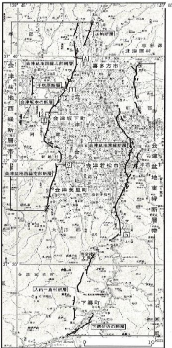
会津盆地西縁・東縁断層帯の位置と主な調査地点 1：新宮地点 2：大川地点 3：見明地点 4：塔寺地点 5 A-C：反射法弾性波探査測線（文献 2） ◎：断層帯の北端と南端 断層の位置は文献 5、6、8、9、10 及び 12 に基づく。 基図は国土地理院発行数値地図 200000「新潟」を使用。
