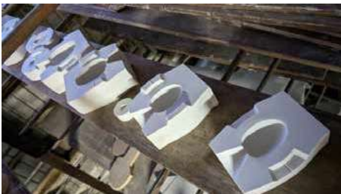
▲ 1 石膏で作った泥漿鑄込み用の型
