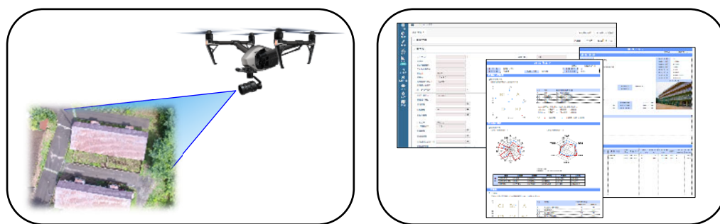
図 7.1 UAVによる屋根・屋上劣化調査とデータベース管理イメージ
