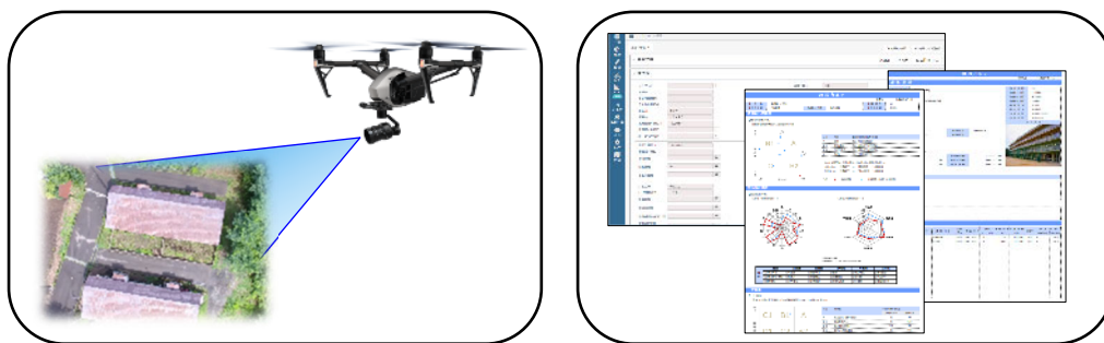
図 8.1 UAVによる屋根・屋上劣化調査とデータベース管理イメージ
