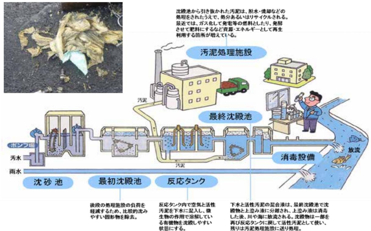
■図2 標準的な下水処理施設の処理工程
